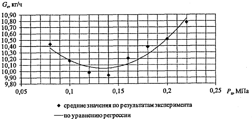
Рисунок 5 – Зависимость расхода топлива G_e от давления в шине переднего колеса P_{\text{п}} (загрузка прицепа на 50%: распределение реакций опорной поверхности на переднее колесо R_{\text{м}} = 5542 Н и заднее колесо R_{\text{з}} = 13\ 615 Н)
