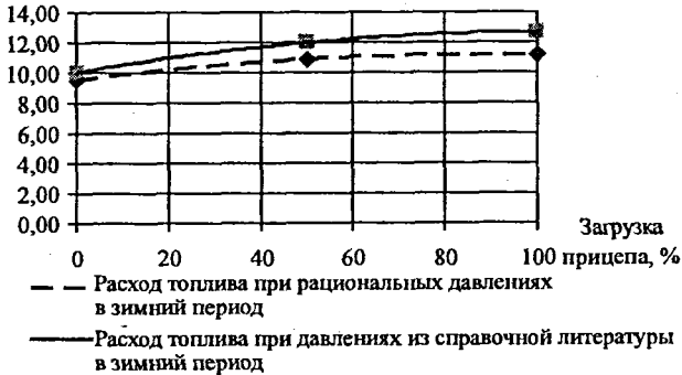
Рисунок 8 – Зависимость изменения расхода топлива от загрузки прицепа при движении по заснеженной опорной поверхности
