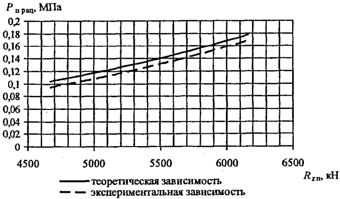
Рисунок 6 – Зависимость изменения рационального значения давления воздуха в шине от изменения реакции опорной поверхности на колесо
