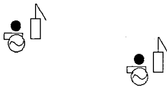
рис. 7 Схема энергообеспечения буровых станков от индивидуальных ДЭС с утилизацией тепла от индивидуальных теплообменников
