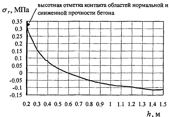
Рис. 2. Изменение главных радиальных напряжений в бетонной крепи по высоте заходки при наличии зоны сниженной прочности (растягивающие напряжения приняты положительными)
