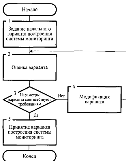
Рисунок 7 – Структурное представление методики построения системы мониторинга в виде блок-схемы алгоритма
