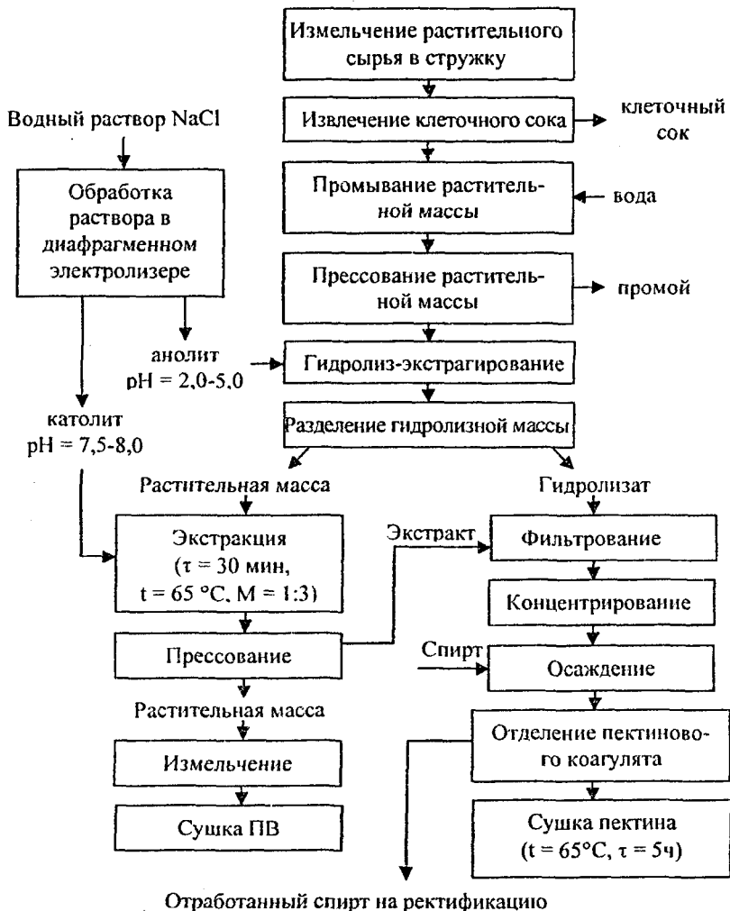
Рис. 6 Схема получения пектина и пищевых волокон из растительного сырья
