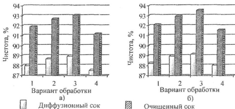
Рис. 2. Зависимость чистоты соков от варианта подготовки свекловичной стружки с применением бентонита (а) и гипса (б) для ЭХА воды: 1 - опрыскивание анолитом; 2 - опрыскивание анолитом, ошпаривание анолитом; 3 - опрыскивание анолитом, ошпаривание католитом; 4 - ошпаривание анолитом, опрыскивание анолитом
