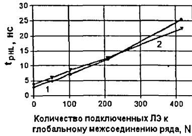
Рис.3. Зависимость задержки распространения сигнала от количества подключенных ЛЭ к цепи ГМС при переключении из 1 в 0 (Spice-модель ws, T=125\text{ }^{\circ}\text{C} , U_{cc}=1.62\text{ В} ): 1 – коммутаторы на п-МОПТ ключах; 2 – коммутаторы на КМОП-ключах
