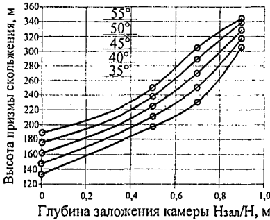
Рис. 5. Зависимости высоты призмы скольжения от места заложения камеры при C = 0,3 МПа, \phi = 30^\circ , высоте откоса H = 360 м с углом \alpha = 45, 50, 55^\circ
