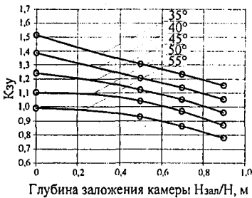
Рис. 6. Зависимости коэффициента запаса устойчивости ( K_{3y} ) от места заложения камеры при C = 0,2 МПа, \phi = 28^\circ , высоте откоса H = 260 м с углом \alpha = 45, 50, 55^\circ
