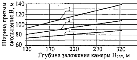
Рис. 1. Зависимости ширины призмы скольжения от глубины заложения камеры в борту карьера глубиной H = 360\text{ м} и углом откоса \alpha = 50^\circ , объем выработки 32 тыс. \text{м}^3 : 1 – на расстоянии 20 м от откоса; 2 – на расстоянии 50 м от откоса; 3 – на расстоянии 100 м от откоса
