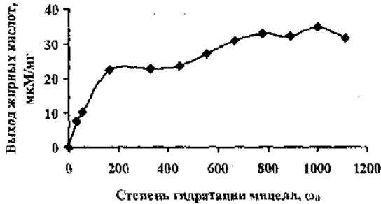
Рис. 7 — Влияние степени гидратации на ферментативный гидролиз льняного масла липазой из Candida rugosa в системе мицелл АОТ
