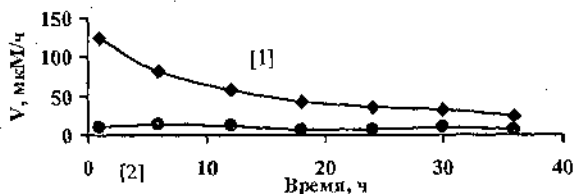
Рис. 4 – Влияние времени на скорость гидролиза льняного масла ферментным препаратом панкреатической липазы: 1 – среда – декан; 2 – среда – вода
