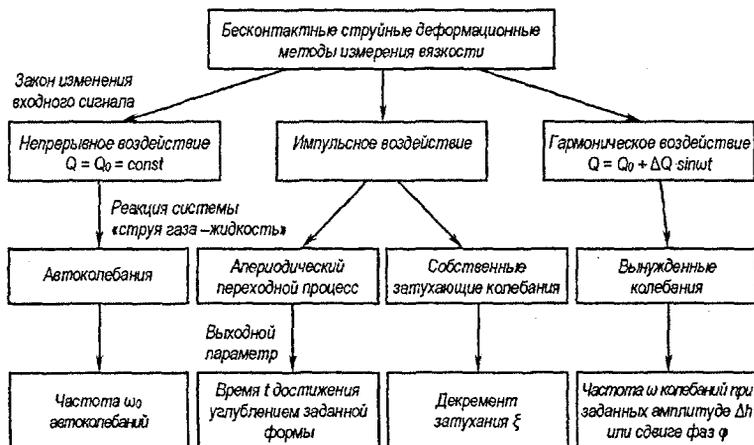
Рис. 5. Классификация бесконтактных струйных деформационных методов измерения вязкости
