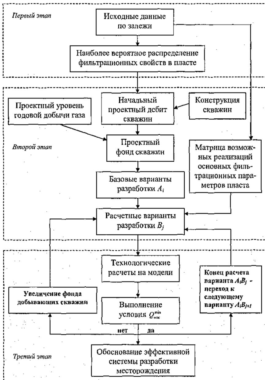
Рисунок – Блок-схема методики выбора эффективной системы разработки морского газового месторождения
