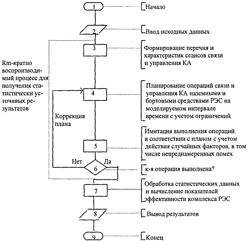
Рисунок 1 – Алгоритм модели функционирования комплекса РЭС, обеспечивающих обмен информацией между наземными и космическими КСр в условиях воздействия непреднамеренных помех
