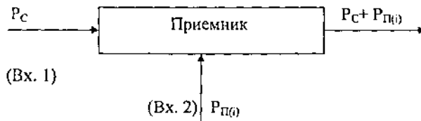
Рисунок 2 – Схема исследования характеристик ЭМС с целью определения эквивалентов для помех различных уровней и форм в виде нормального стационарного шума
