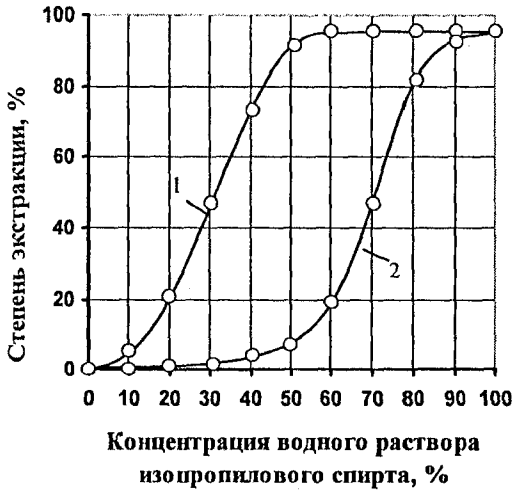
Рисунок 2 – Влияние концентрации водного раствора изопропилового спирта на степень экстракции:
