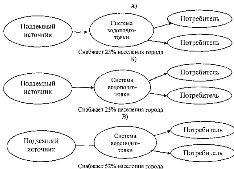
Рис. 1. Схема 3 водозаборов и распределение воды в г.Дзержинске (А – городской водозабор; Б – поверхностный водозабор из р.Ока; В – Тепловский водозабор).
