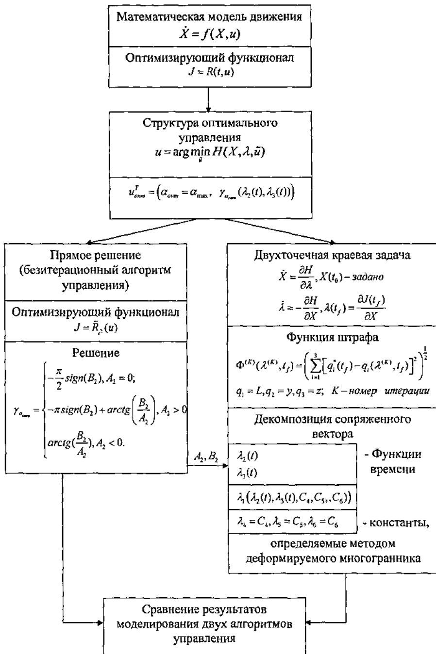
Рис. 3.2. Блок-схема решения оптимизационных задач управления
