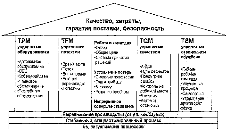
Рис.1. – Общая модель производственной системы
