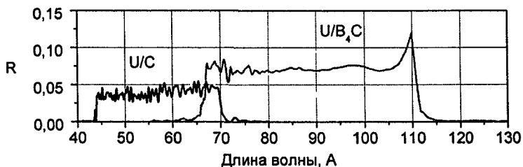
Рис 8 Коэффициент отражения аперидических зеркал U/C и U/B 4 C (100 пар слоев), оптимизированных на максимальное равномерное отражение при нормальном падении излучения
