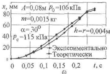
Рис. 7. Законы движения сортируемых деталей: а – латунь; б – сталь
