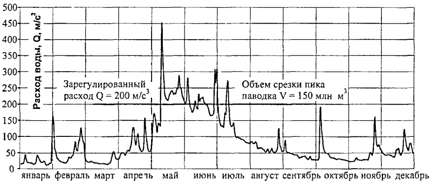
Рис 8 Определение объема «срезки» пика паводка по гидрографу р. Белая, х. Кирпичный
