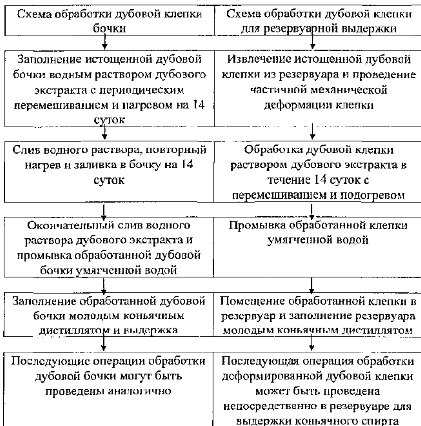
Рисунок 4 – Схема обработки истощенной дубовой клепки
