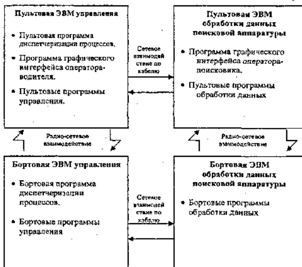
Рис. 1. Структурная схема системы управления и обработки данных поисковой аппаратуры МРК
