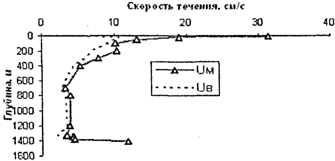
Рис. 2. Модуль скорости ( U_M ) и модуль векторной ( U_B ) скорости течения ( \text{см}\cdot\text{с}^{-1} ) на ст. 7 км от м. Кадыльный в сентябре 1971 г.
