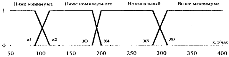
Рисунок 3 – Модель фильтра после параметрической настройки
