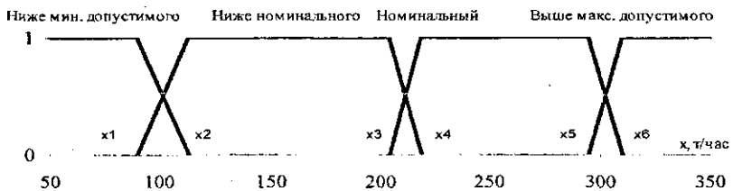
Рисунок 4 – Модель режимов работы фильтров настроенная при помощи критерия (35)
