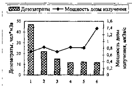
Рис.9. Дозозатраты при ремонте арматуры Ду300 АЭС с РБМК-1000 (в расчете на одну задвижку): 1...6 – ремонтные кампании в 2001...2004 гг.
