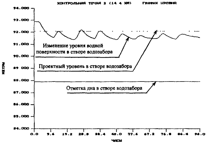
Рисунок 11- Пример результатов численных экспериментов - изменение уровней в створе водозаборов
