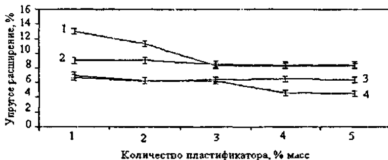
Рисунок 2 - Зависимость упругого расширения прессовок из сплава ВК8 от количества и вида пластификатора: 1- ПЭГ, 2 – ПЭГ-ПВА, 3 – ПВА, 4 – СК
