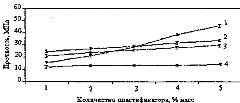
Рисунок 3 - Зависимость прочности (на сжатие) прессовок из смеси сплава ВК8 от количества и вида пластификатора: 1- ПВА, 2 – ПЭГ, 3 – ПЭГ-ПВА, 4 – СК.
