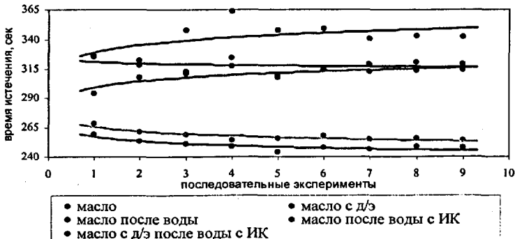
Рисунок 4 – Время истечения вазелинового масла через капилляр.
