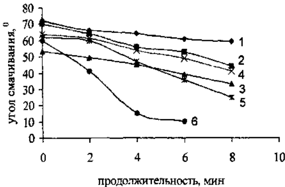
Рис. 3. Измерение краевого угла смачивания композита ПЛ+ГАП (1-ПЛ, 2-20% ГАП(д), 3-30% ГАП(д), 4-40% ГАП(д), 5-20% ГАП(мд), 6-30% ГАП(мд))
