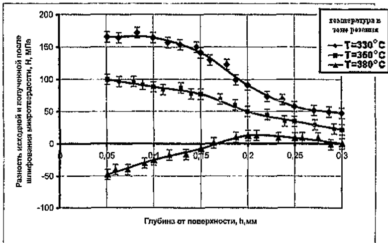
Рис. 6. Изменение микротвердости поверхностного слоя в зависимости от режимов шлифования
