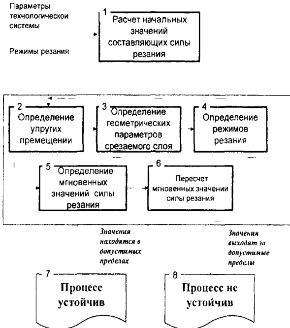
Рисунок 10 - Схема определения виброустойчивости технологической системы с учетом устройства стабилизации силы резания
