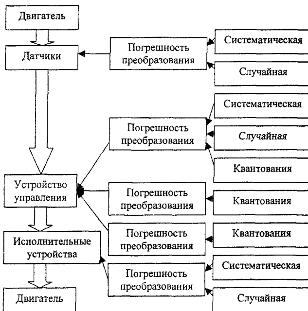
Рис 5 Структура источников погрешности при диагностике рабочего процесса двигателя
