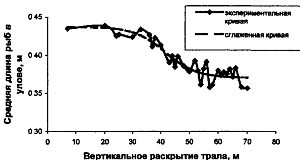
Рис. 15. Зависимость средней длины минтая в уловах от вертикального раскрытия входного устья трала
