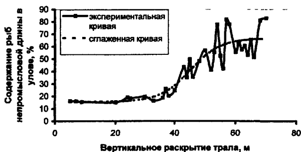
Рис. 16. Зависимость содержания рыб непромысловой длины в улове от вертикального раскрытия устья трала
