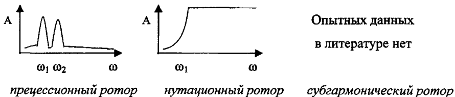
Рис. 1. Экспериментальные амплитудно – частотные характеристики ротора с нецентральным диском.
