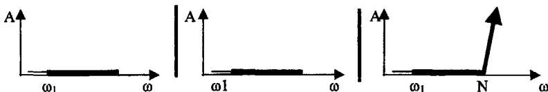
Рис. 4. Амплитудно – частотная характеристика ротора с нецентральной диском.
