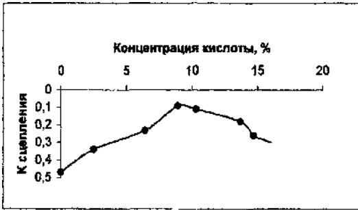
Рис.3. Зависимость адгезионных свойств пенококса от концентрации ортофосфорной кислоты.
