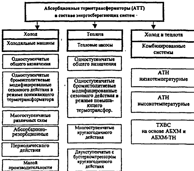
Рис. 1. Схема классификации абсорбционных термотрансформаторов в составе энергосберегающих систем
