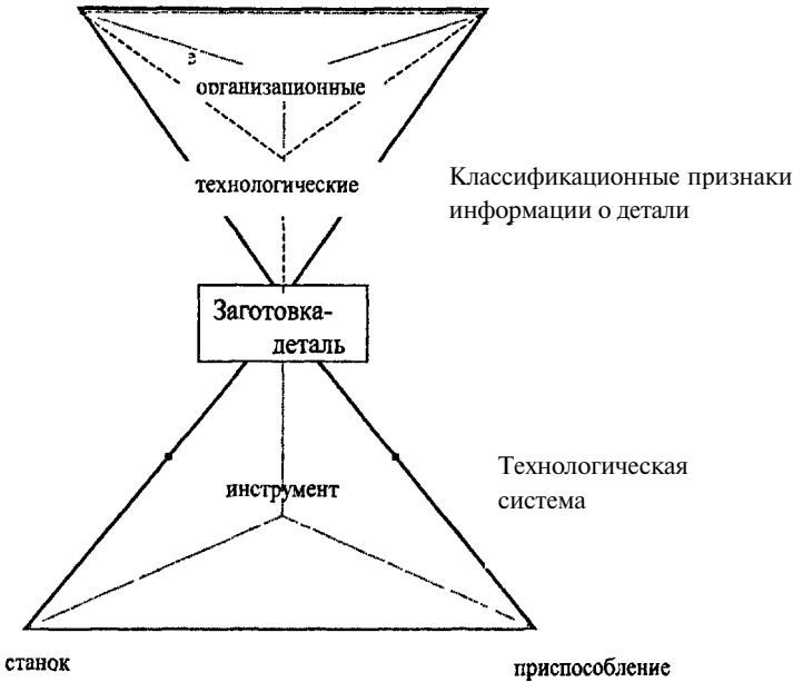
Рис. 4. Схема механизма информационного отбора (взаимодействие технологической системы с заготовкой для получения классификационных признаков детали)
