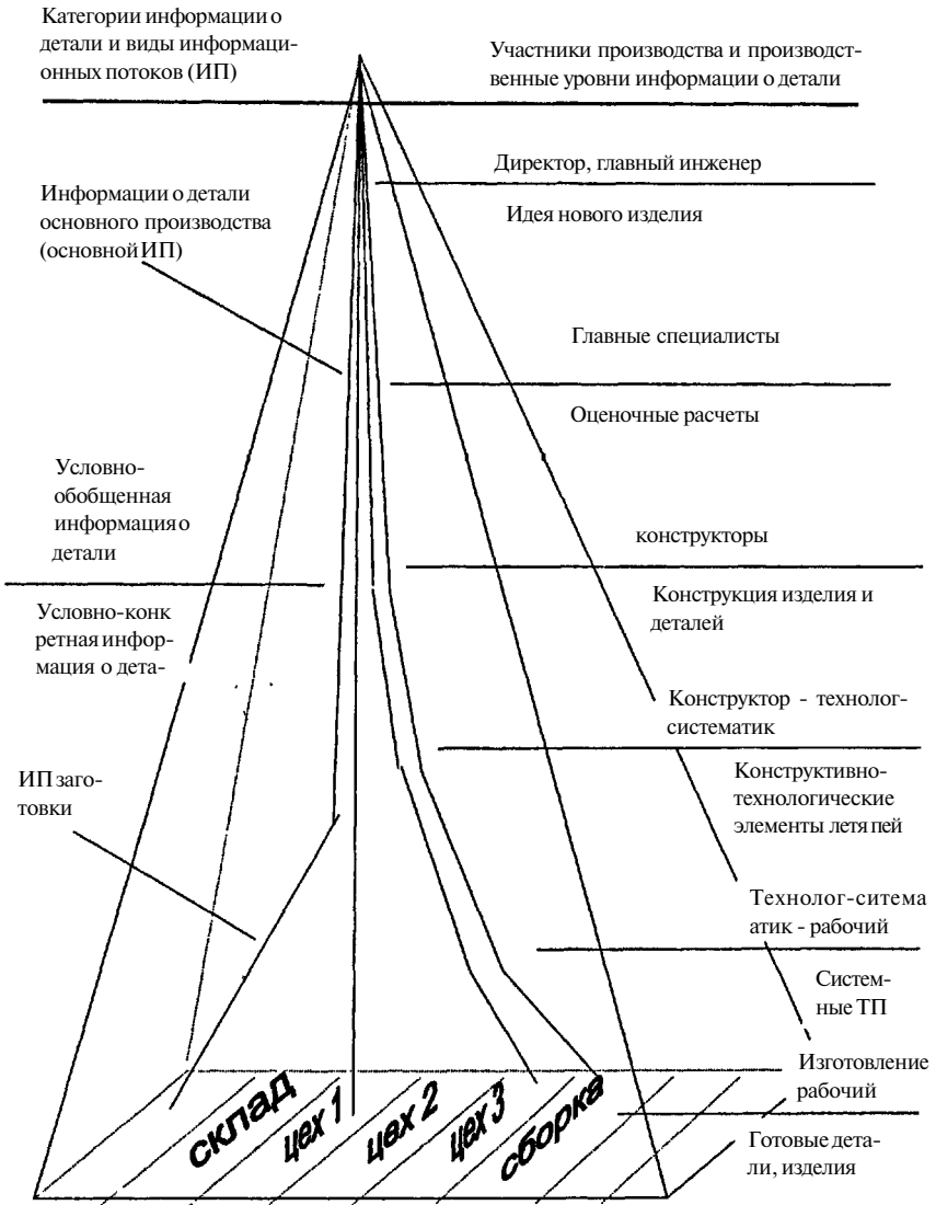
Рис. 1. Модель системной технической подготовки и управления машиностроительным производством на основе ИП информации о детали
