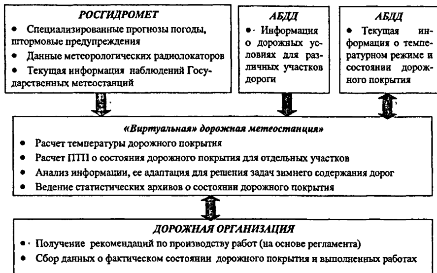
Рис. 6. Схема информационного обмена для проекта «виртуальной дорожной метеостанции»
