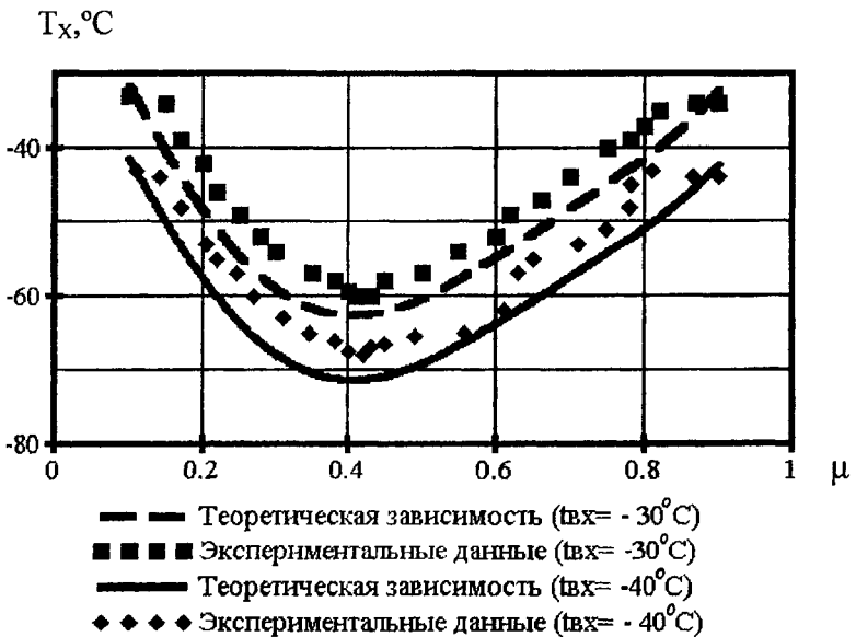
Рис. 3. Расчётные и экспериментальные значения температуры холодного потока
