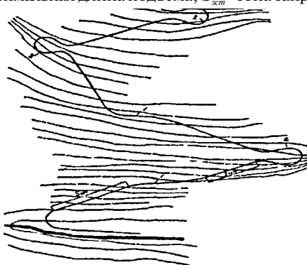
Рис. 11. Развитие трассы по склонам с использованием оптимальной длины подъема S_{опт} - оптимальная длина подъема; 1 - уполаживающий участок; 2 - серпантин, как уполаживающий участок
