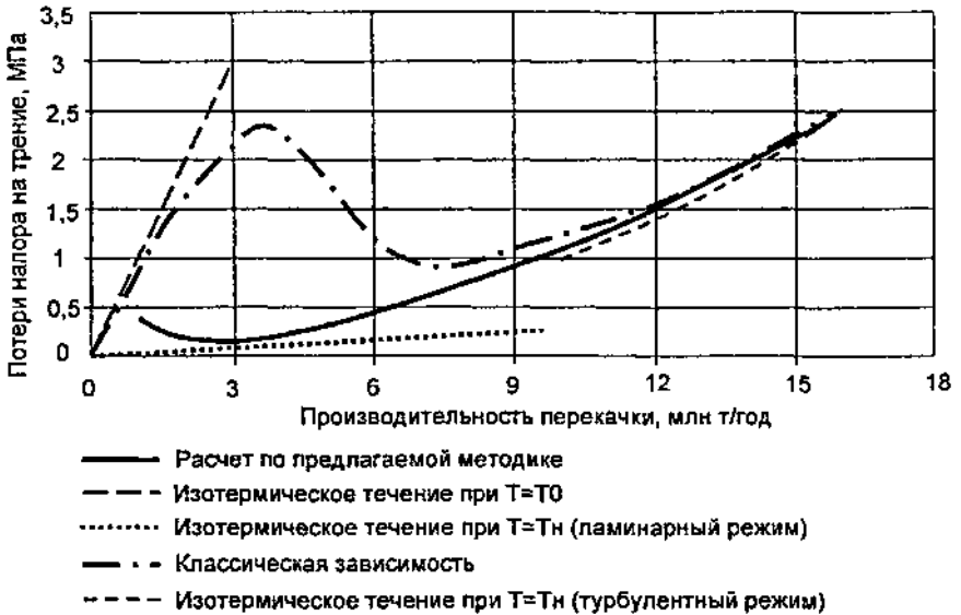
Рисунок 1 - Зависимость гидравлического сопротивления от производительности неизоотермического трубопровода
