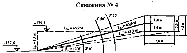
Рис. 6. Схема расположения водоспускных скважин при бурении с рабочего пола № 1
