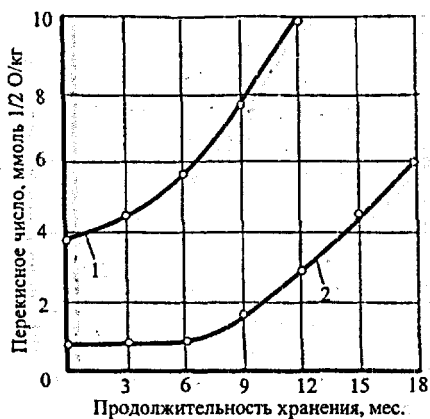
Рисунок 2.6 – Изменение перекисного числа в процессе хранения рафинированных дезодорированных кукурузных масел, полученных по технологии: 1 - традиционной; 2 - разработанной
