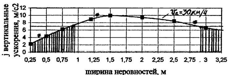
Рис.10. Влияние ширины неровностей (при высоте 0,1м) на вертикальные ускорения, действующие на водителя автомобиля ВАЗ 2121
