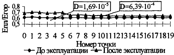
Рисунок 10 - Распределение коэффициента термоэлектрической чувствительности на участке режущей кромки реза с напайкой твердосплавной титановольфрамовой пластиной 0025 Т5К10 ГОСТ 25395-90 до и после эксплуатации с двумя выкрашенными точками (1 и 5)
