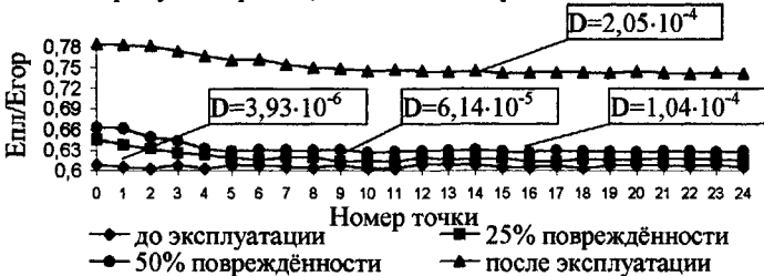
Рисунок 9 - Распределение коэффициента термоэлектрической чувствительности на участке режущей кромки резца с напайной титановольфрамовой пластиной 0025 Т5К10 ГОСТ 25395-90 до эксплуатации и с разной степенью износа (скорость резания V \approx 108 м/мин)
