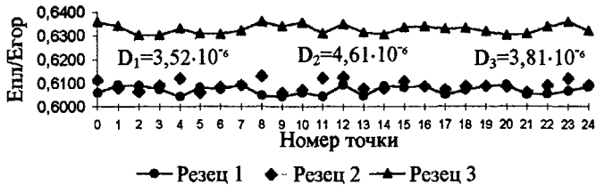
Рисунок 6 - Распределение коэффициента термоэлектрической чувствительности на участке режущей кромки новых резцов с напайными твердосплавными титановольфрамовыми пластинами 0025 Т5К10 ГОСТ 25395-90
