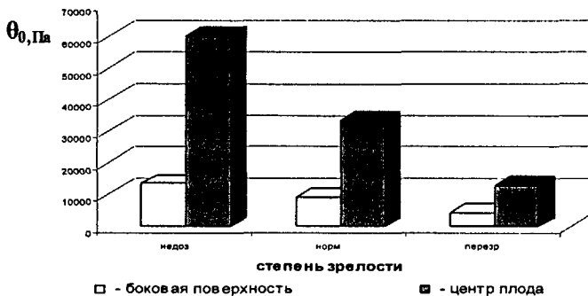
Рис. 8 Гистограмма зависимости предельного напряжения плода от степени зрелости плода.
