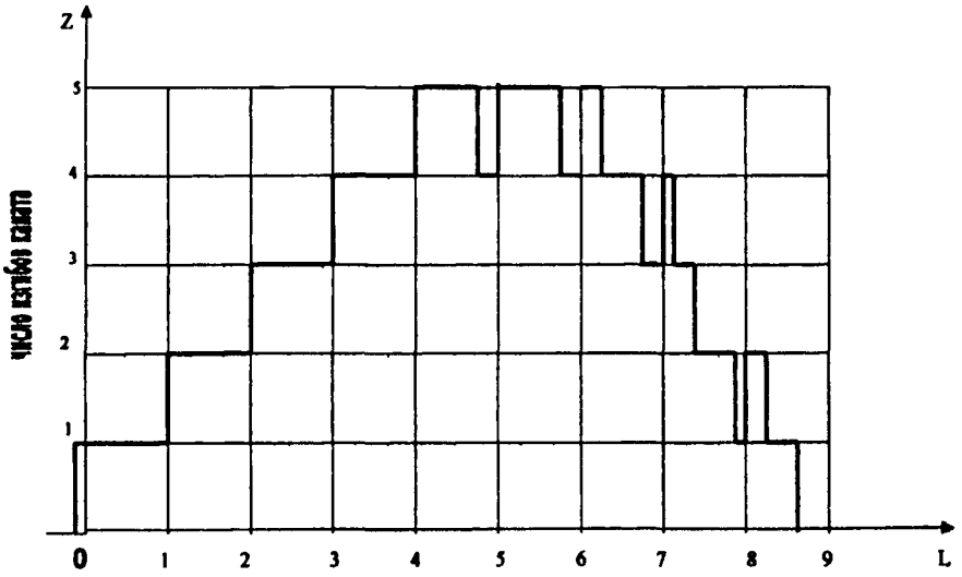
Рис. 3. Зависимость распределения числа изгибов по длине в оснастке талевой системы БУ-2500ЭУ при подъеме талевого блока на высоту одной свечи длиной 25 м.
