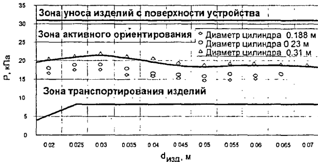
Рис. 9. Зависимость давления активного ориентирования от диаметра изделий при одинаковой удельной нагрузке, d_0 = 0.0004 м, t_{\text{щ}} = 0.005 м.
