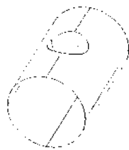
Рис.2. Оболочка с отверстием и системой определяющих вмятину точек
