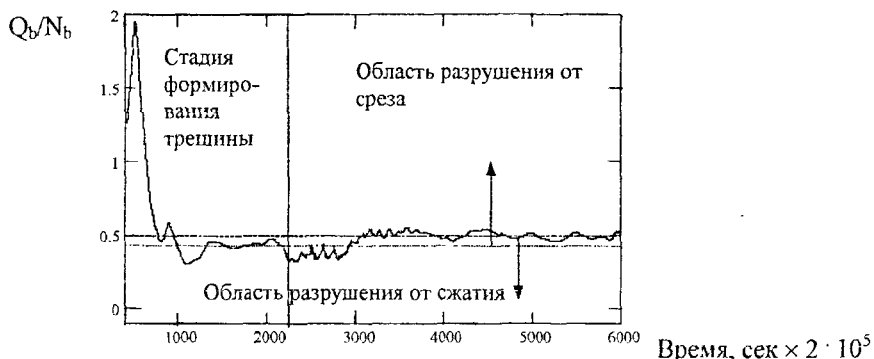
Рис. 7 Изменение зависимости Q_b/N_b в процессе увеличения прогиба для угла наклона трещины 20^\circ . Динамическая нагрузка q(t)=\text{const} .
