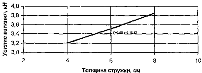
Рис. 2. Зависимость усилия копания от толщины стружки в заданных пределах при влажности W = 12\% и прочности C = 3 уд.
