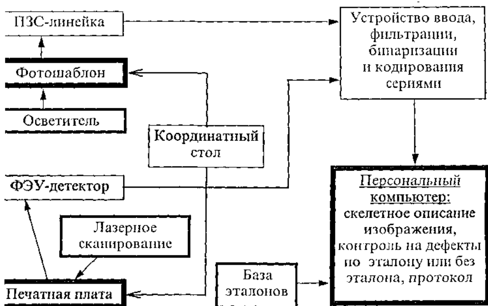
Рис. 7. Структурная схема системы контроля
